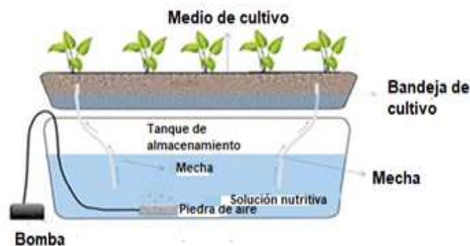
Figura 1. Esquema del sistema hidropónico de mecha.
